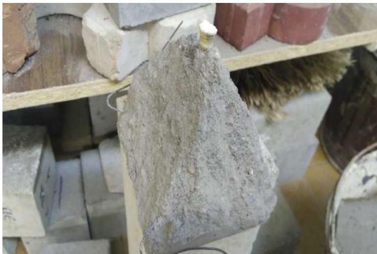
Рисунок 1. Образец со стеклопластиковой арматурой после испытаний на прочность
