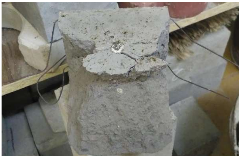
Рисунок 2. Образец со стеклопластиковой арматурой после испытаний на прочность
